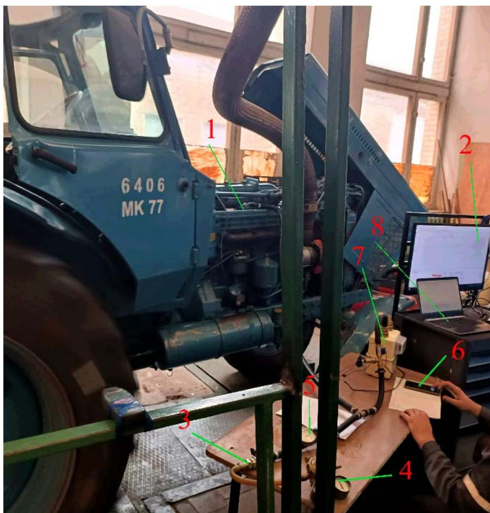
Рисунок 4.9 – Экспериментальные исследования при измерении объема картерного пространства двигателя № 248100 в составе трактора МТЗ-80:
