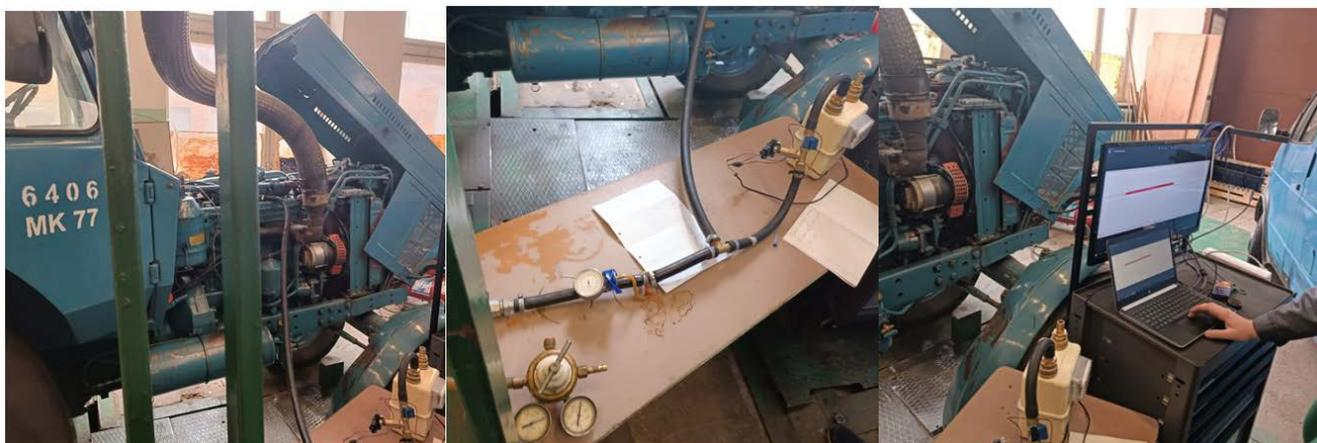
Рисунок 4.4 – Монтаж измерительной системы на двигатель Д-240 № 248100 в составе трактора МТЗ-80.
