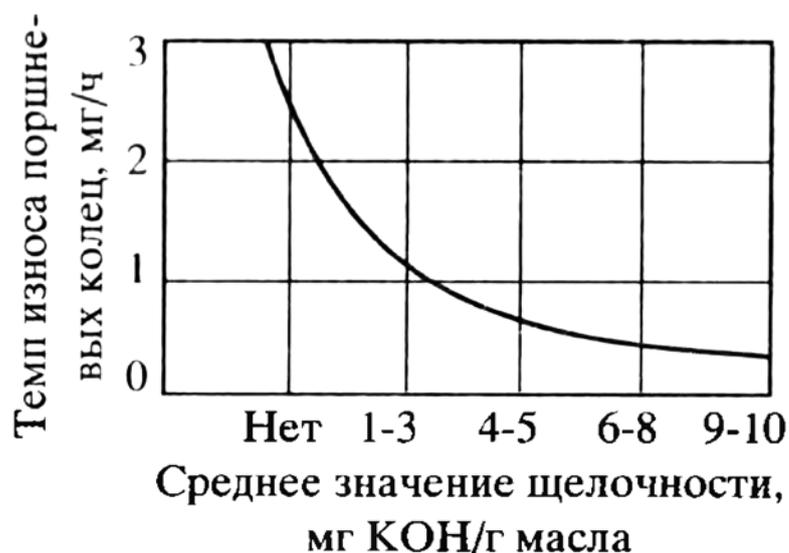
Рисунок 1.2 – Скорость износа поршневых колец при работе дизеля на маслах с разным щелочным числом ОН
