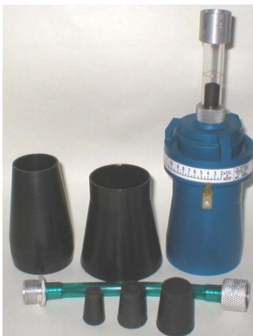
Рисунок 1.6 – Расходомер картерных газов КИ-17999М
