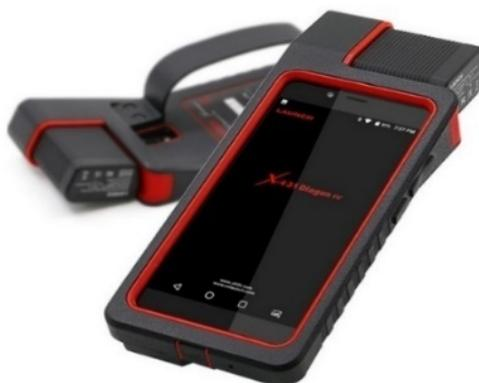
Рисунок 1.8 – Диагностический сканер Launch X431 Diagon IV
