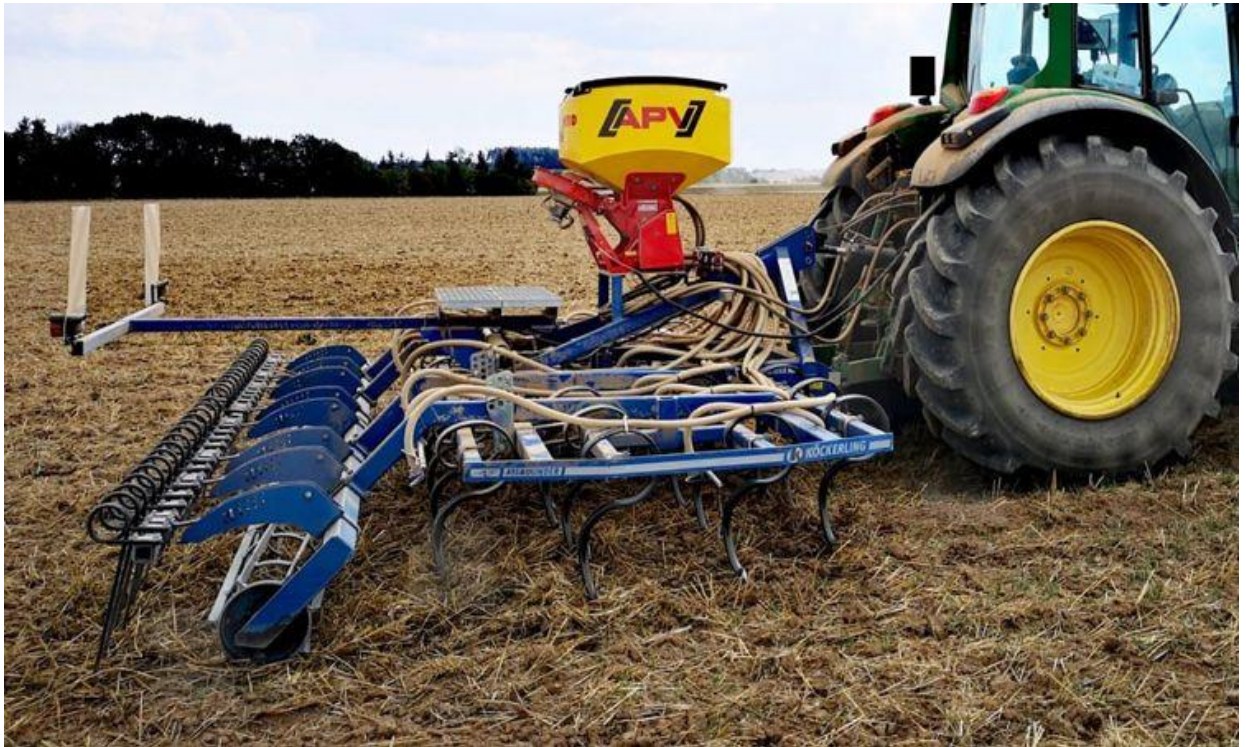
Рисунок 1.13 - Пневматическое высевальное устройство TWIN в работе
