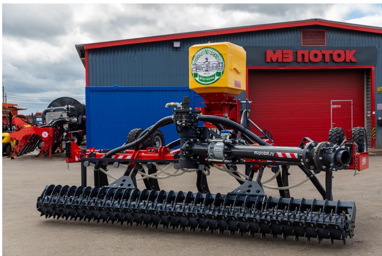
Рисунок 3.2 - Опытный образец комбинированного агрегата для одновременного внесения жидкого навоза через шланговую систему и посева сидератов (вид сзади)
