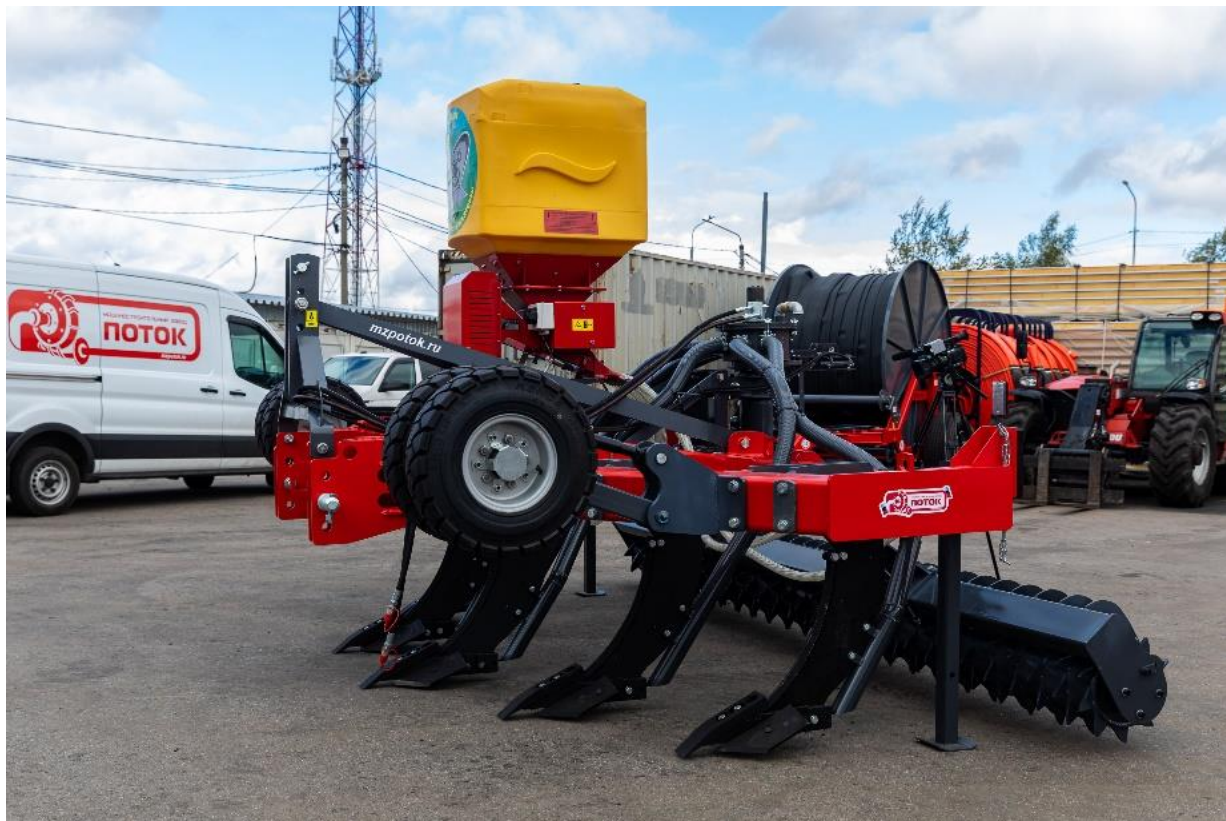
Рисунок 3.1 - Опытный образец комбинированного агрегата для одновременного внесения жидкого навоза через шланговую систему и посева сидератов (вид сбоку)
