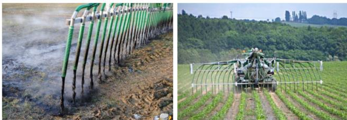
Рисунок 1.3 - Поверхностное внесение ЖОУ через распределитель с системой навесных шлангов
