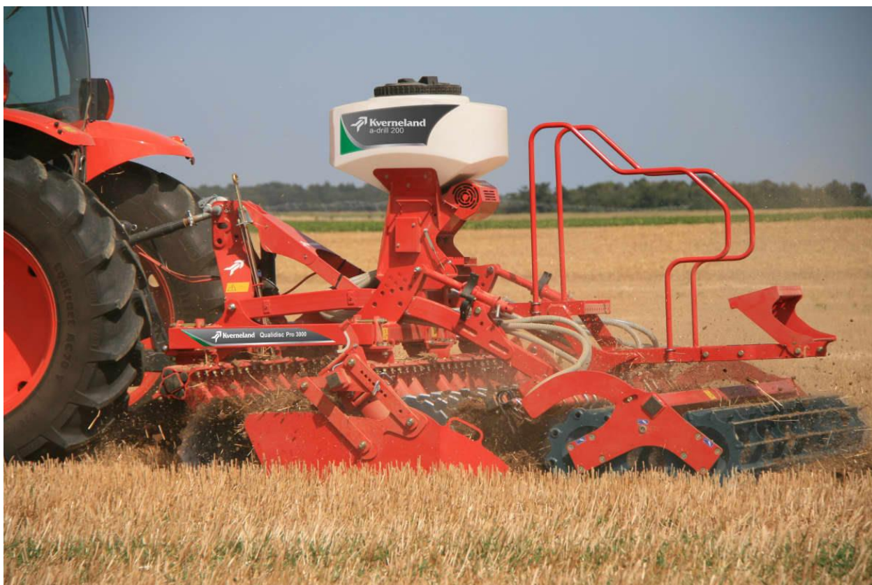
Рисунок 1.14 - Пневматическая сеялка Kverneland a-drill для высева сидеральных культур одновременно с обработкой почвы культиватором или дисковой бороной
