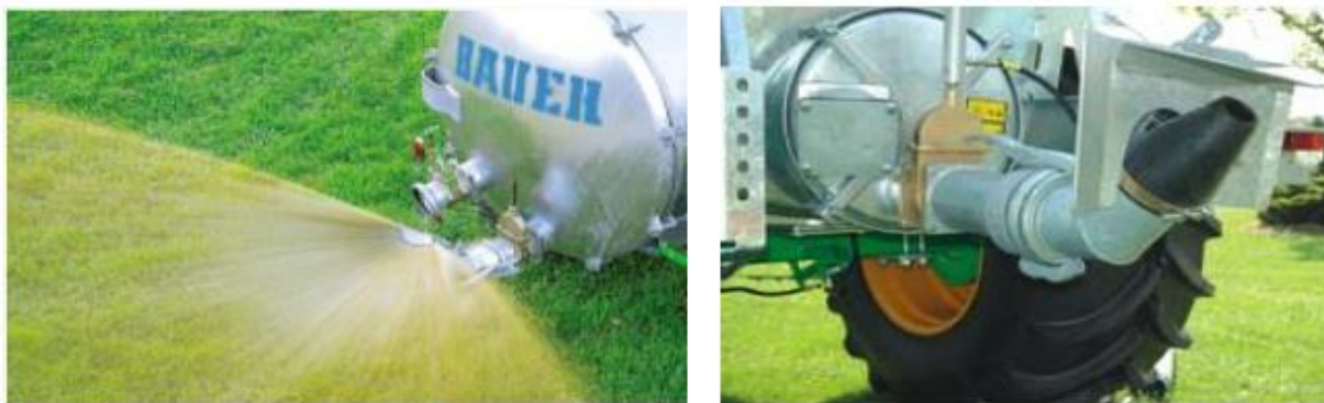
Рисунок 1.2 - Поверхностное внесение ЖОУ разбрызгиванием
