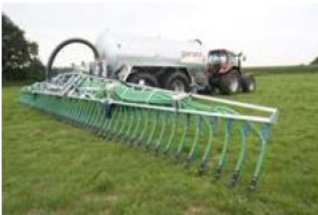
Рисунок 1.4 - Поверхностное внесение ЖОУ через распределитель с башмачной системой навесных шлангов
