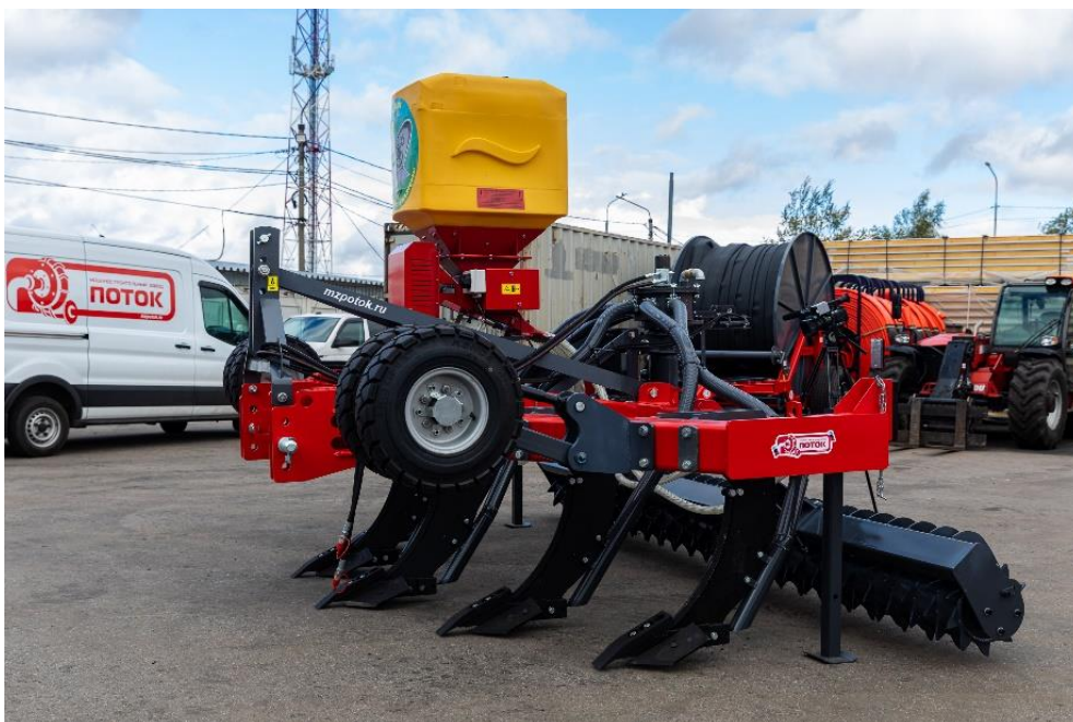
Рисунок 4 – Опытный образец комбинированного агрегата для одновременного внесения жидкого навоза через шланговую систему и посева сидератов (вид сбоку)
