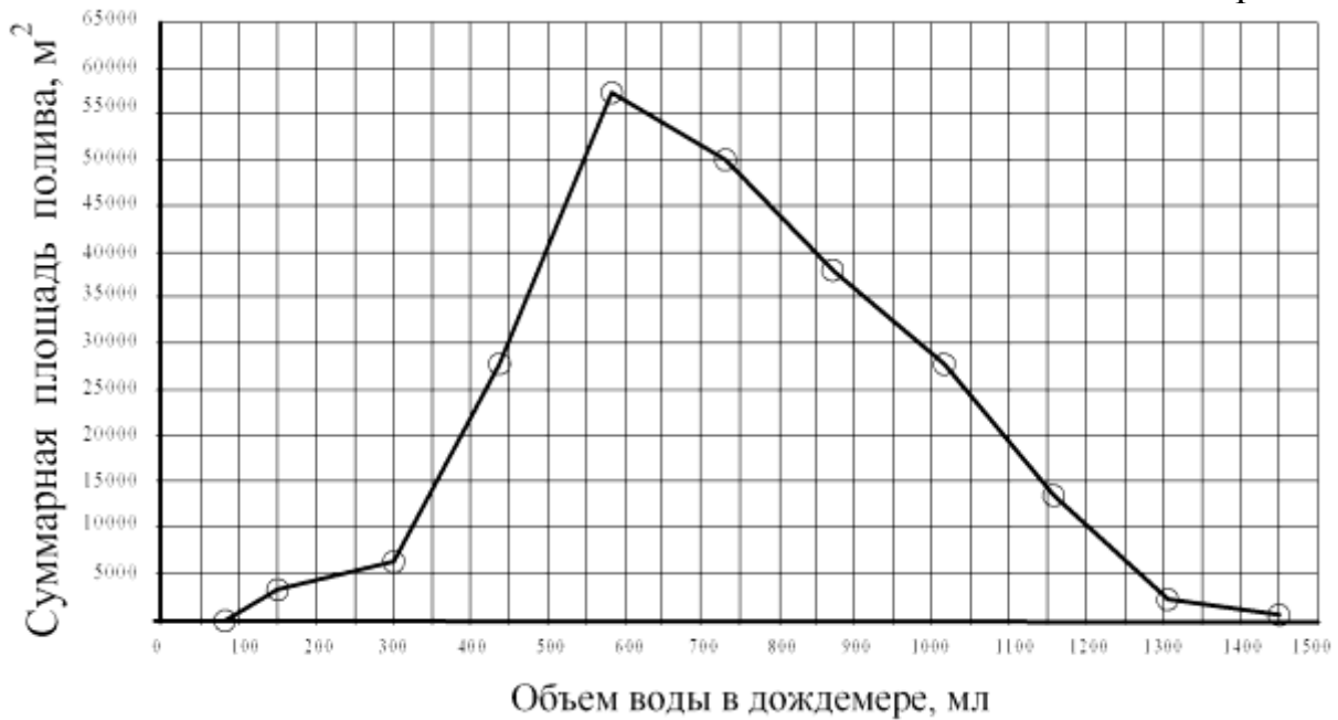
Рисунок 1 – Распределения воды в дождемерах ДМ «Фрегат» K_{ЭП} = 0,74 ; K_{НП} = 0,12 ; K_{ИЗП} = 0,14 , скорость ветра 4 м/с
