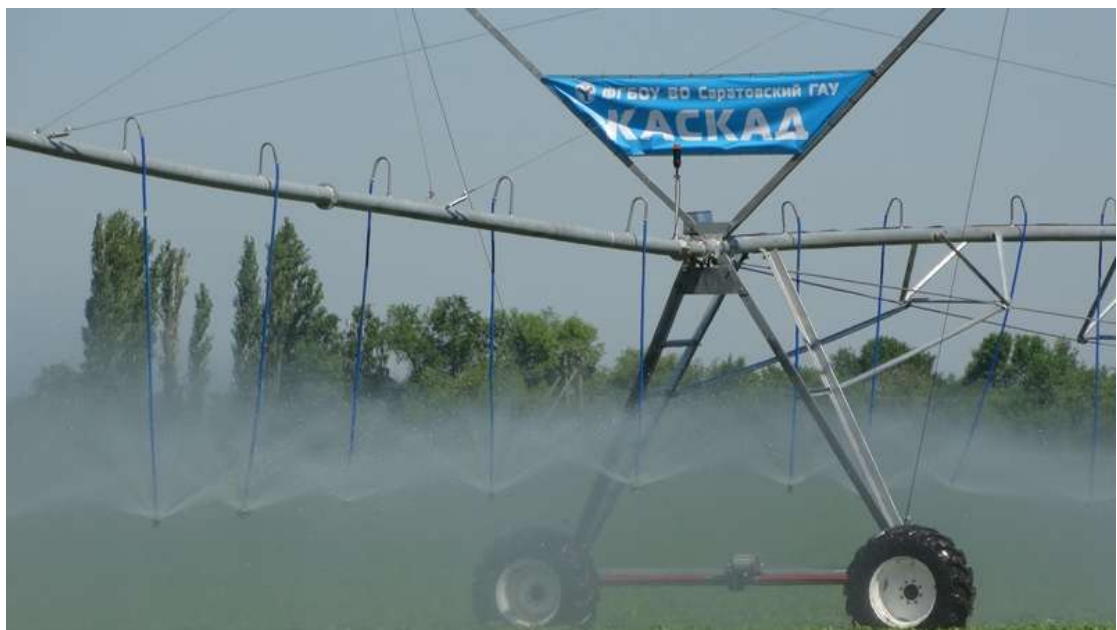
Рисунок 3.3 – Электрифицированная дождевальная машина КАСКАД
