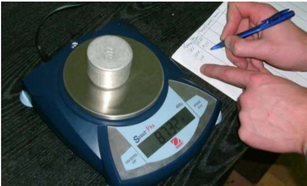
Рисунок 3.6- Определение влажности почвы
