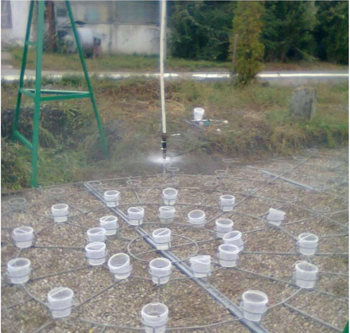
Рисунок 3.4 - Определение характеристик дождевателей
