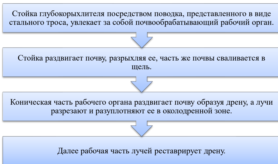
Рисунок 2.5 – Принцип работы кротодренирующего рабочего органа
