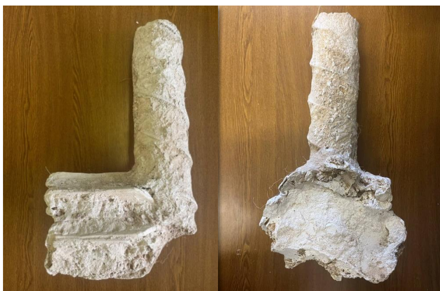
Рисунок 4.16 – Гипсовый слепок кротодрены
