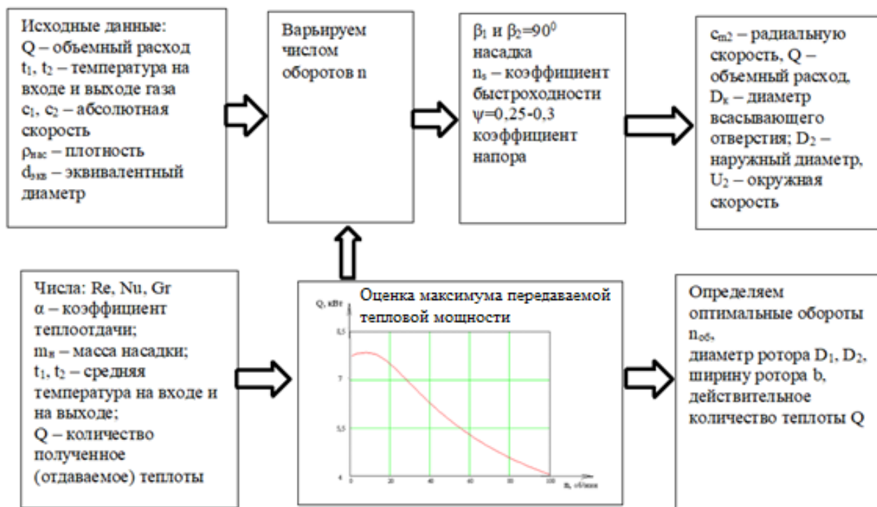
Рисунок 2 – Последовательность расчета вращающегося регенеративного воздухонагревателя
