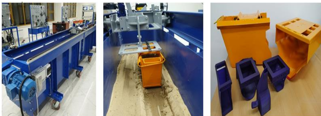
Рисунок 6 – Испытание модели рабочего органа каналоочистителя прямоугольного профиля на грунтовом лотке
