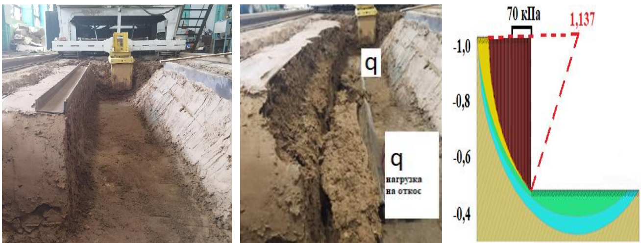
Рисунок 9 – Величина запаса устойчивости при вертикальном откосе канала с распределенной нагрузкой на берме недостаточна в данных условиях
