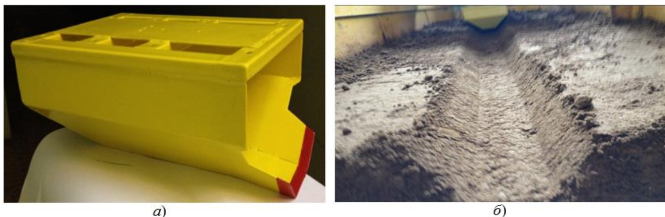
Рисунок 5 – Физическая модель ковша каналоочистителя: а) общий вид, б) в работе
